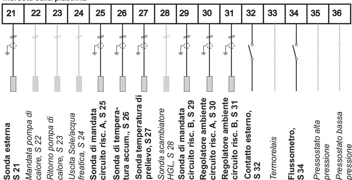
Le sonde **di temperatura di mandata** per i circuiti di riscaldamento utilizzati sono sempre necessarie. Devono essere montate alle rispettive condutture di mandata e collegate ai morsetti 25 e 29.
