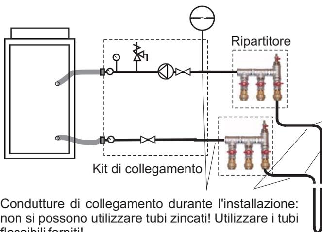
Condutture di collegamento durante l'installazione: non si possono utilizzare tubi zincati! Utilizzare i tubi flessibili forniti!
