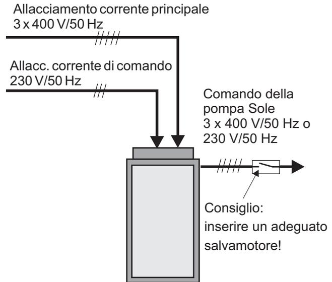
Per la **limitazione della corrente di avviamento** può essere inserito un dispositivo apposito con cui le correnti di avviamento vengono ridotte di ca. il 50% (ad avvenuta equilibratura della pressione):
