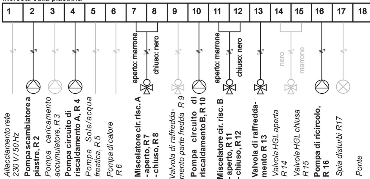
**Morsetto 2: pompa dello scambiatore a piastre** in combinazione con IDM-Hygienik.
