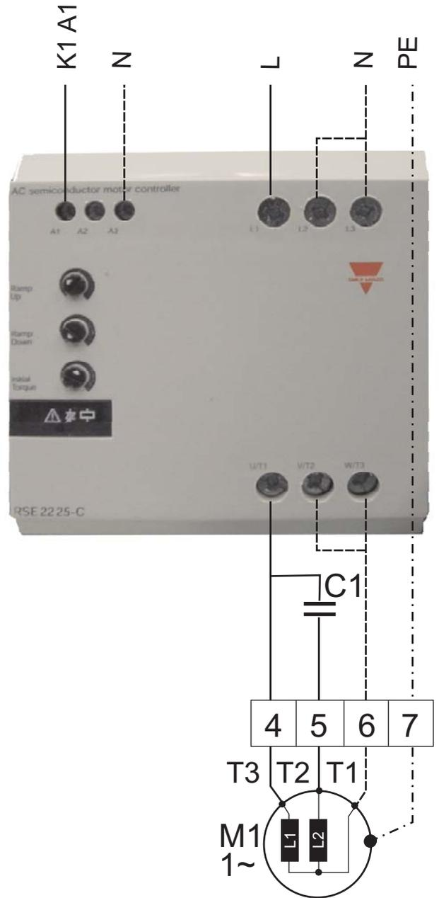
**L1 = Bobina principiale:** bobina a basso valore Ohm
