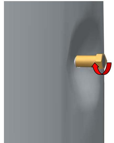
3. Inserire la guarnizione ed avvitare la valvola di miscelazione.
