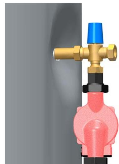
5. Avvitare anche la condotta di miscelazione inserendo prima la guarnizione.
