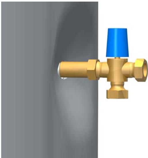
4. Avvitare il gruppo pompa con l'avvitamento olandese alla valvola di miscelazione. Non dimenticare la guarnizione!
