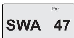
SWA 47 = il valore teorico della regolazione a valore assoluto è 47°C. La temperatura sulla sonda T2 viene quindi mantenuta costante a 47°C.
