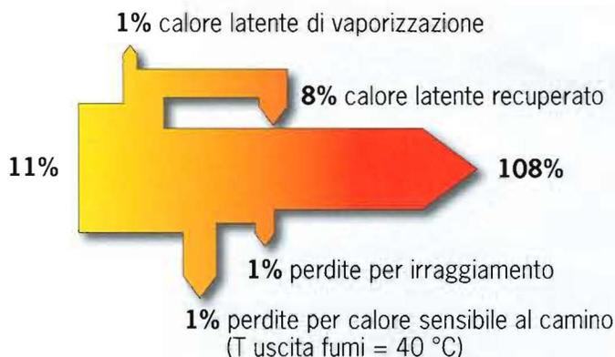
3 Perdite di calore e rendimento di una caldaia a condensazione in riferimento al PCI del combustibile.
