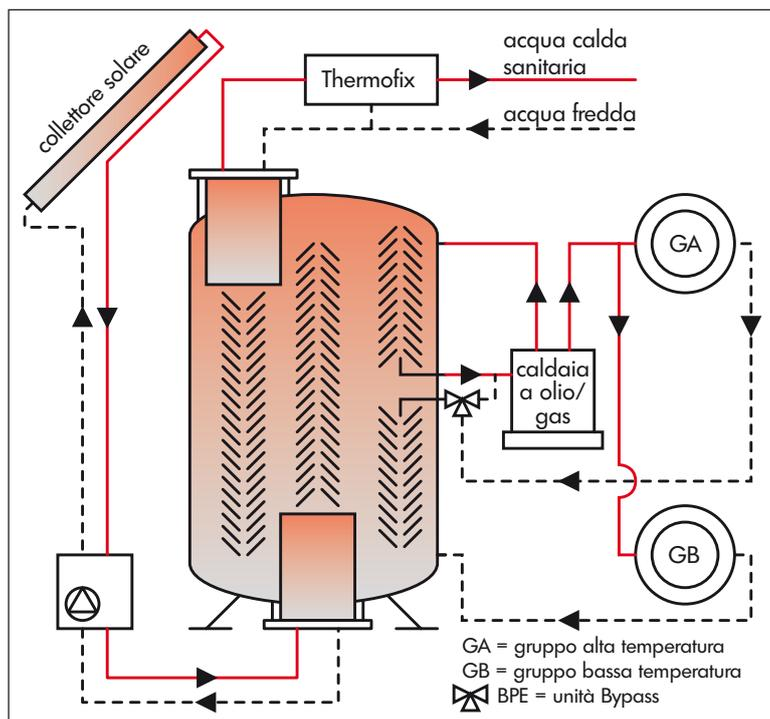
Imm. 16.1: Rappresentazione schematica d'un accumulatore termico HYBRID con modulo acqua sanitaria intergrata, completo di Thermofix; Produzione di calore complementare: caldaia a olio, gas, pellets o resistenza elettrica
