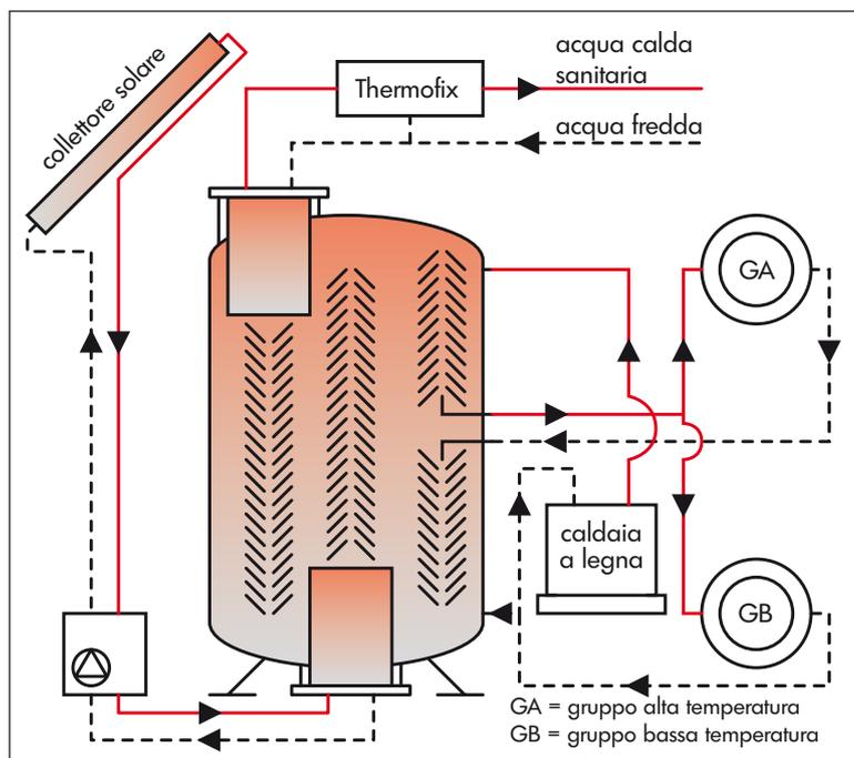
Imm. 16.2: Rappresentazione schematica d'un accumulatore termico HYBRID con modulo acqua sanitaria intergrata, completo di Thermofix; Produzione di calore complementare: caldaia a legna o resistenza elettrica
