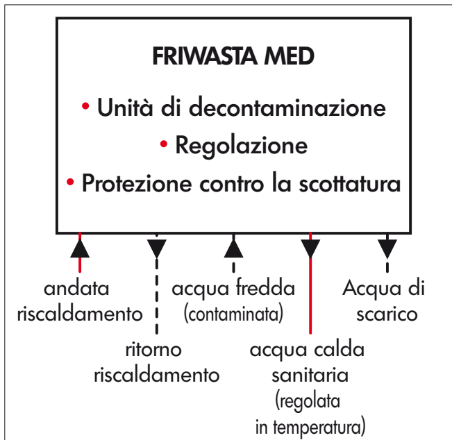
Imm. 9.2: Schema idraulico: FRIWASTA MED
