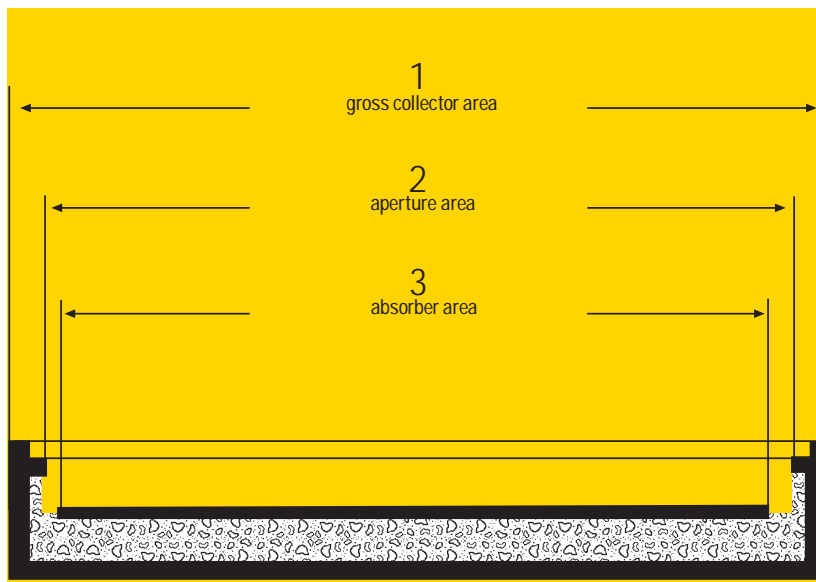
Figura 3 - Definizione delle differenti aree di un collettore
