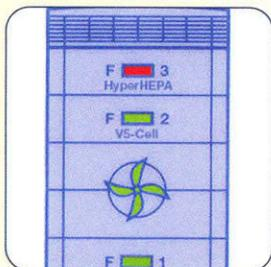
**Eliminazione ottimale di gas e odori** – IQAir® HealthPro 250 utilizza il filtro V5-Cell™ – il più avanzato filtro contro gas e odori disponibile in un depuratore d'aria per ambienti confinati. La sostanza granulare consiste in una miscela specifica di carboni attivi e allumina impregnata per la rimozione di un'ampia gamma di gas e odori sgradevoli.
