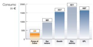
Per una piscina a skimmer di dimensioni 10x5m profondità 1,35m, con copertura isotermica, in zona temperata. Temperatura impostata: 28°, periodo di utilizzo 15 Maggio - 15 Settembre.
